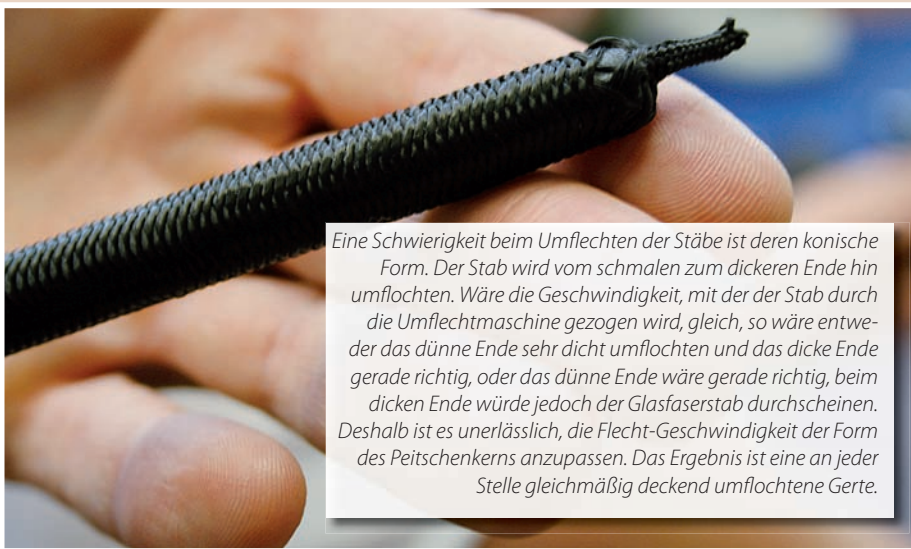
Die Glasfaser-Gerten erhalten eine Spitze aus geflochtenem Polypropylengarn. Die Spitzen sind aufgeklebt und mit doppelseitigem Klebeband fixiert.
