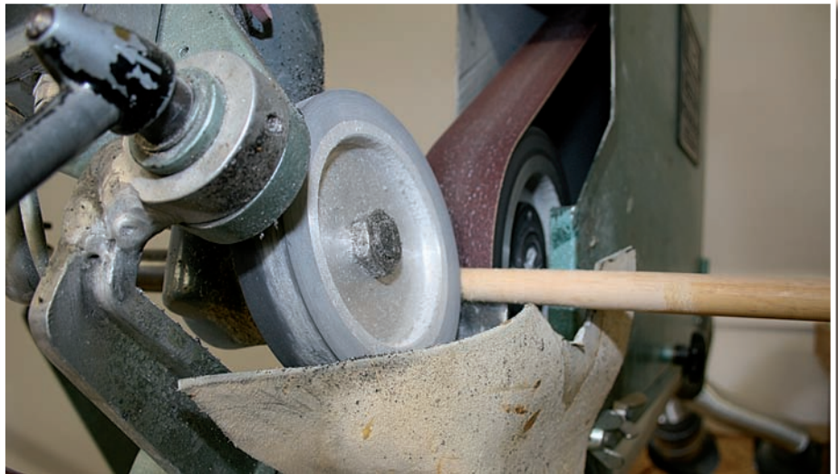
Das Manilarohr wird an der Schleifmaschine in die gewünschte Form geschliffen.
