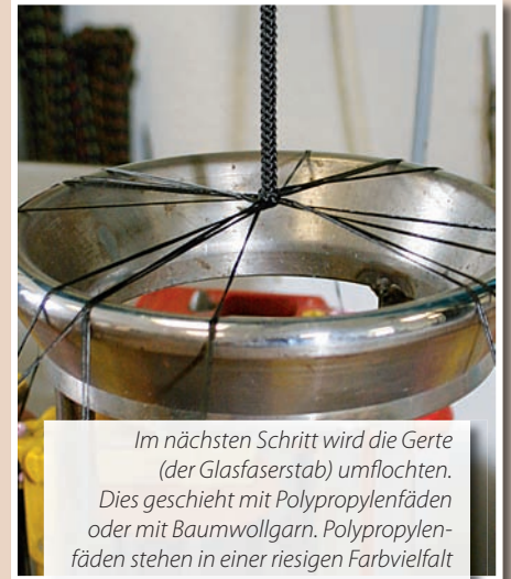
Die Glasfaser-Gerten erhalten eine Spitze aus geflochtenem Polypropylengarn. Die Spitzen sind aufgeklebt und mit doppelseitigem Klebeband fixiert.
